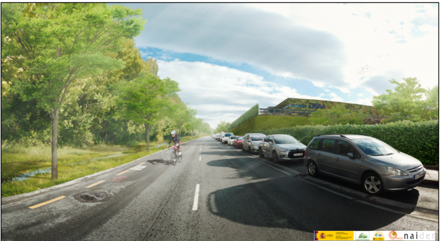
Polígono industrial de Lanbarren (Oiartzun), zona naturalizada con biocanales, arborización lineal y muros y fachadas verdes proveyendo de servicios ecosistémicos como purificación del aire, amortiguación del ruido, recreo y gestión del agua de lluvia.
